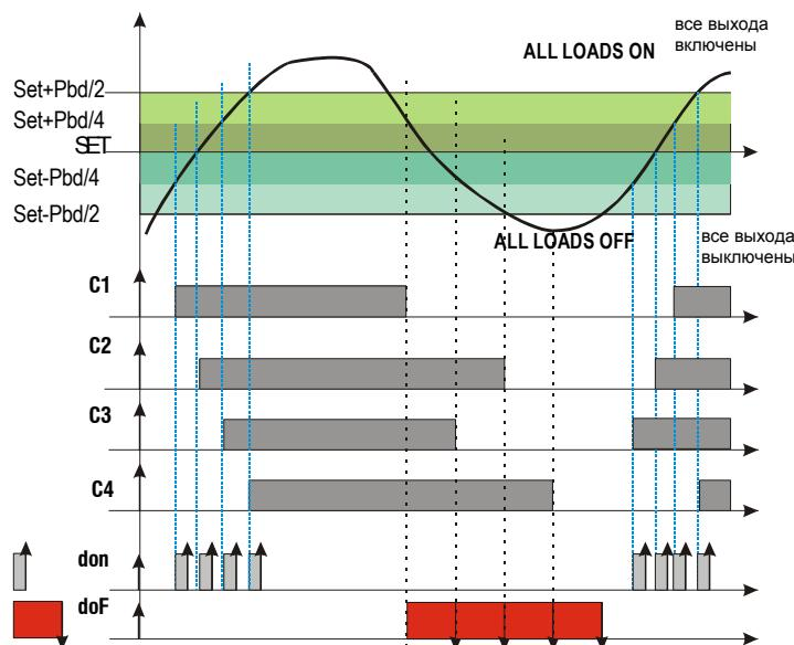
Этот график иллюстрирует время *doF*: нагрузки выключаются только по истечении времени *doF*.
